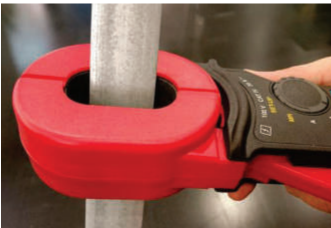
Messung an Bänderder mit CA 6418 dank länglichem Messkopf
